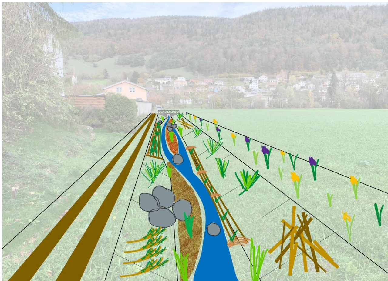
Figure 64: Illustration du secteur superficiel aval avec des mesures de génie biologique et avec le chemin d'entretien en rive gauche. Le replat en rive droite ne fait pas partie du projet mais pourra être comptabilisé en SPB selon le souhait du propriétaire.
