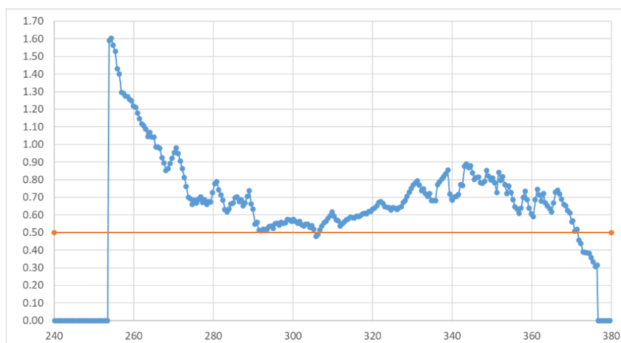
Figure 61: Recouvrement entre le sommet de la conduite PRV et le terrain naturel.
